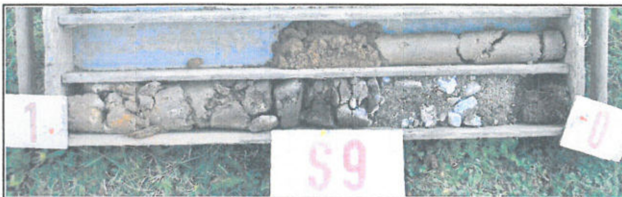
Obr.č. 18: Pohled na geologický profil sondy S9 , hluboké 1,5 m. Svrchní část tvoří zpevňující lomová štěrkodrt' 0-32 mocnosti 400 mm zarostlá drnovým krytem , založená do reliktní písčité hlíny . Od hloubky 0,6 m zastižen hlinitý písek , od 0,8 m jíl písčítý se štěrkem , pevné konzistence. Od 1,4 m přechod do hnědorezavého písku, ulehlého. Podzemní voda v sondě nezastižena.
