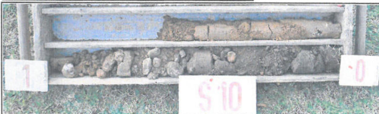
Obr.č. 20: Pohled na geologický profil sondy S10 , hluboké 1,6 m. Pod vegetačním humózním horizontem tl. 0,2 m zastižena písčítá hlína , drobná, drobně štěrkovitá. V hloubce 0,5 m dokumentován hlinitý písek velmi ulehlý , hrubě štěrkovitý, od 0,8 m jíl písčítý, pevný , drobně štěrkovitý. Od úrovně 1,2 m přechod do hnědorezavého slabě hlinitého písku, ulehlého. Podzemní voda se v sondě neprojevovala.
